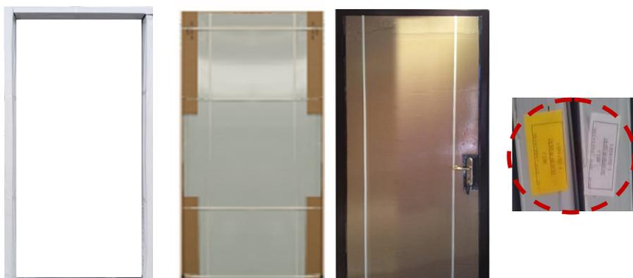
注 (可选配): 下框用 U 型方槽遮盖, 钢板厚度 0.8mm, 两竖框自地面起 1.2m 包覆木盒防撞, 或配置无纺布袋+8mm 防护棉套, 防止小推车通行时的撞击。
