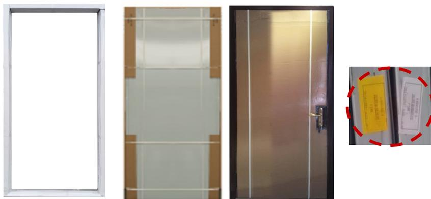
2、门框成品保护（选配）：下框用 U 型方槽遮盖，钢板厚度 0.8mm,两竖框自地面起 1.2m 包覆木盒防撞，防止小推车通行时的撞
